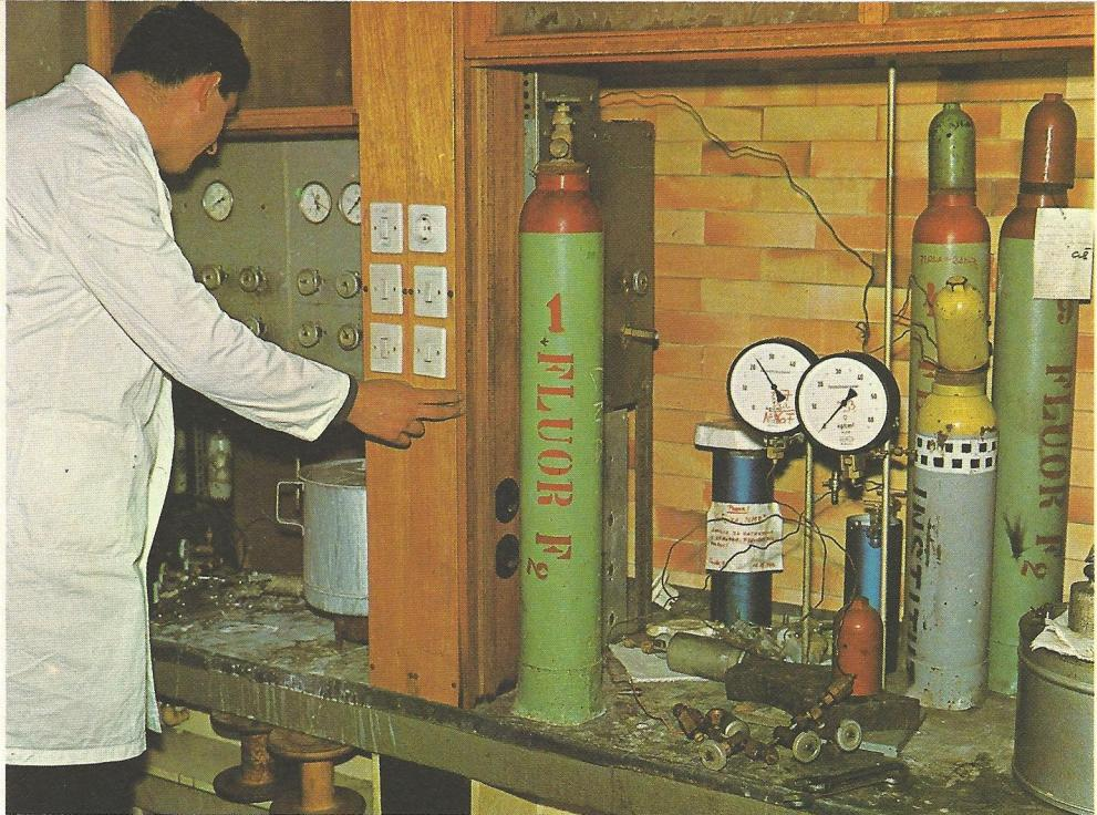
1 Sistem za polnjenje jeklenk s fluorom pod pritiskom
